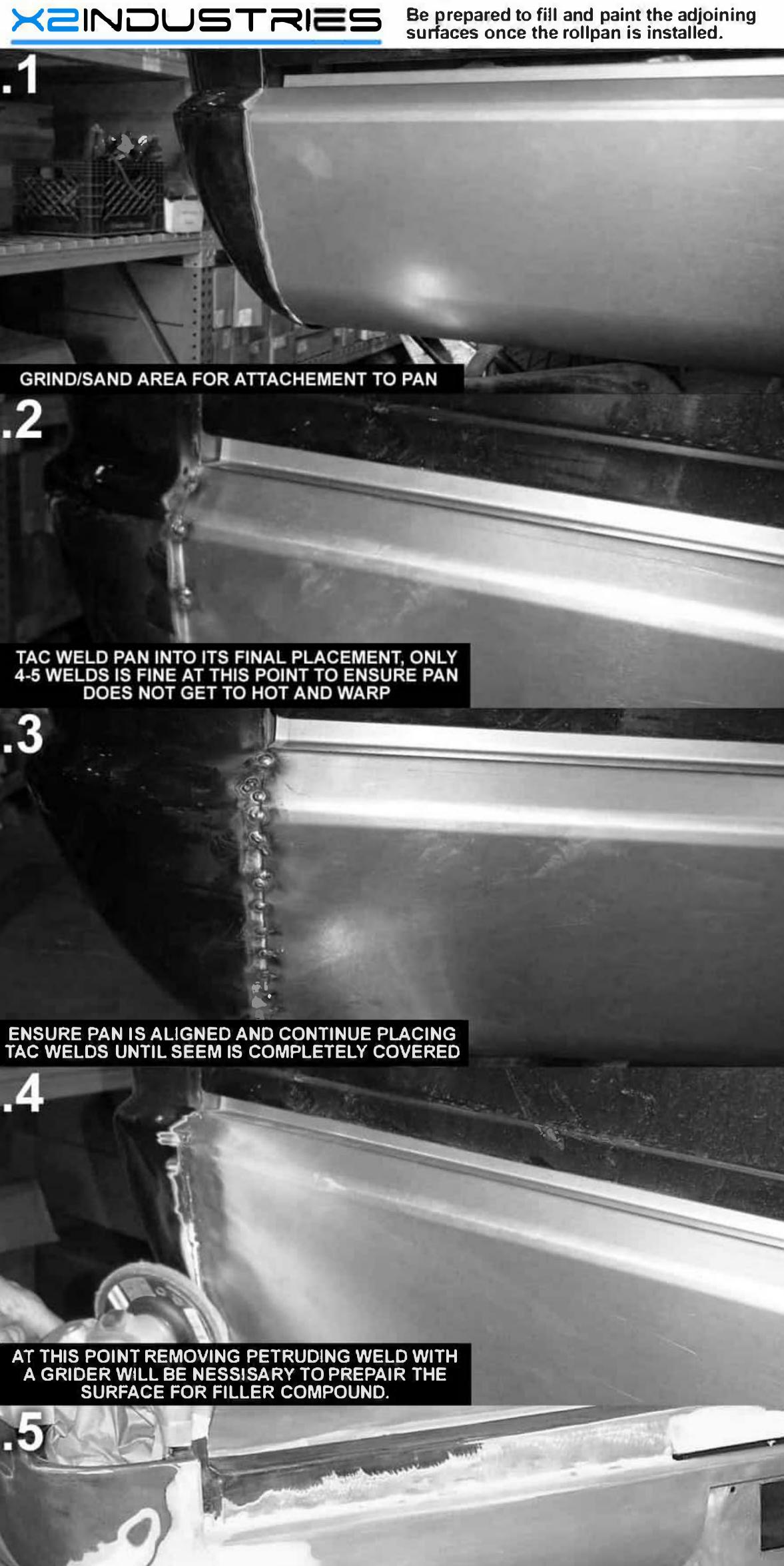
USING A SMALL 3LB HAMMER FOR TAPPING THE WELDS INTO THE BODY TO ENSURE THE WELD SURFACE DOES NOT EXCEED THE BODY SURFACE, IS SUGJESTED IF GRIDNING DOES NOT DO THE TRICK COMPLETELY.
